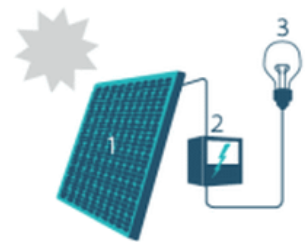
1. Zonnepaneel | 2. Omvormer | 3. Elektrische toestellen
